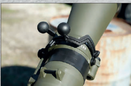
Nella parte posteriore troviamo le manette d'apertura del tromboncino di sfiatò.
