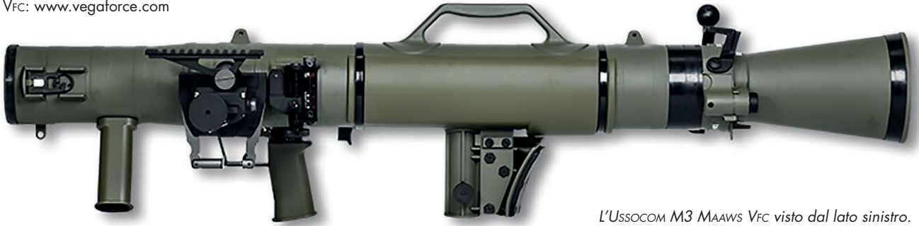
L'Ussocom M3 MAAWS VFC visto dal lato sinistro.
