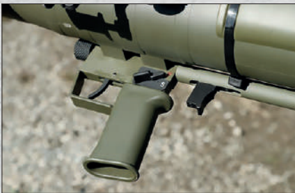
La grip posteriore, dotata di grilletto e relativo ponticello, va impugnata con la mano destra. Si noti la leva d'armamento retrostante.
