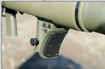
Il poggiaspalla è provvisto di cuscinetto in gomma e integra, nella parte posteriore, l'attacco per il bipiede.
