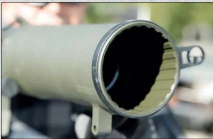
Attraverso la volata si scorge la finta rigatura. La bocca da fuoco è in calibro 84 mm.
