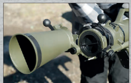
Veduta posteriore del tromboncino aperto con un modulo di lancio inserito.
