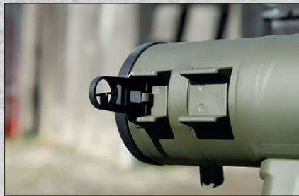
Il mirino flip-up è sul lato sinistro, dato che l'arma va appoggiata alla spalla destra.
