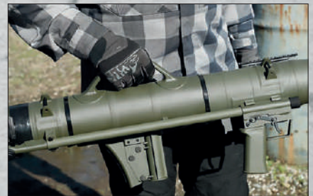
Il maniglione di trasporto e gli agganci per l'imbracatura si trovano sulla parte superiore del tubo lanciatore.
